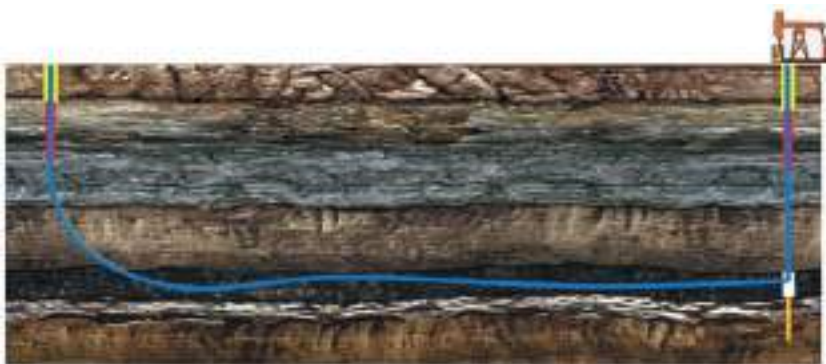
Рисунок 4. Технология добычи МУП с применением гидроразрыва пласта
