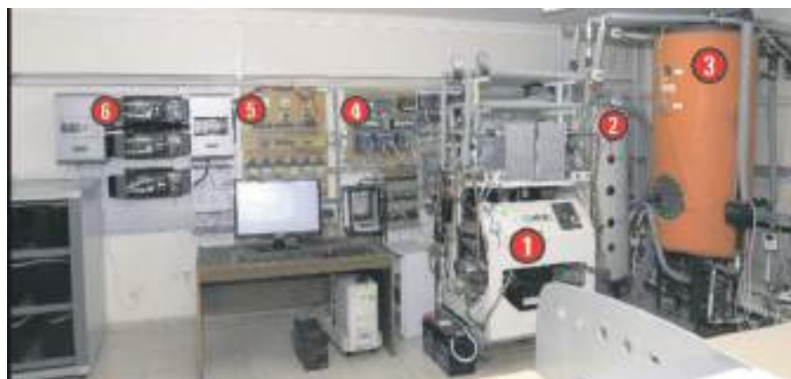
Рисунок 4. Экспериментальная тригенерационная установка с системой интеграции дополнительных энергоисточников на основе ВИЭ
